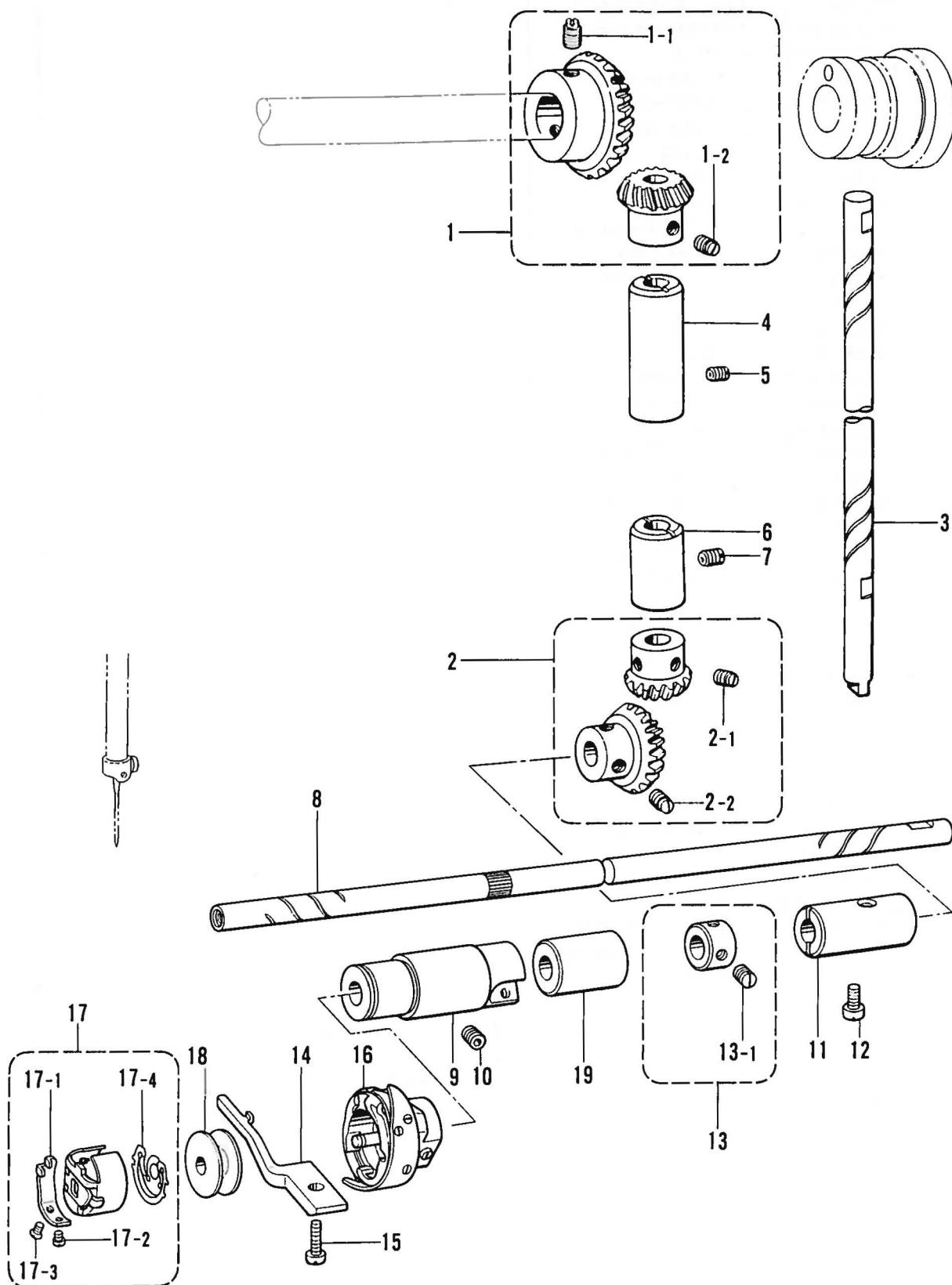
G. カマ関係 / Rotary hook mechanism / Greifervorrichtung /
