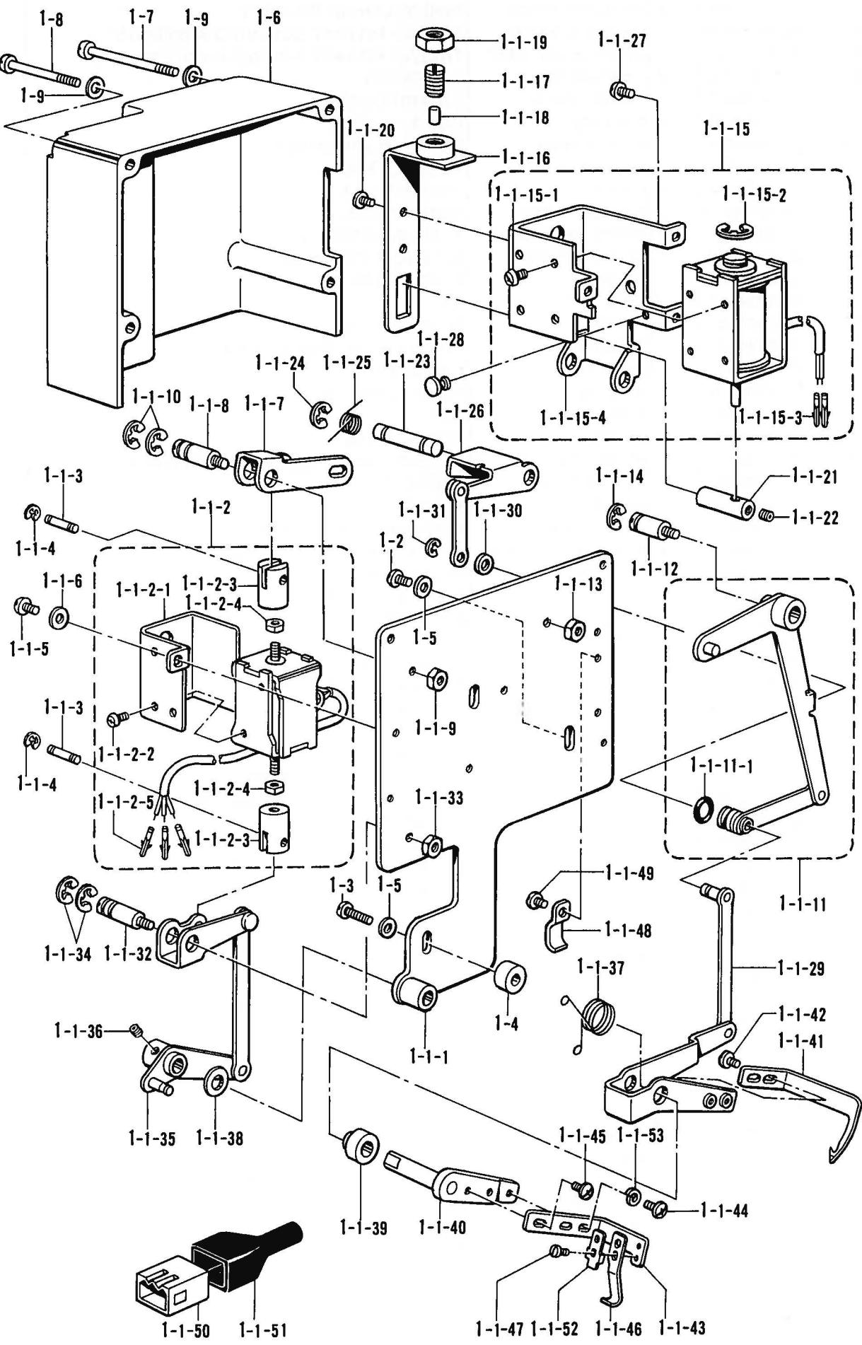
N. 糸ツカミ関係 / Thread clamp mechanism / Nahtanfänge /
