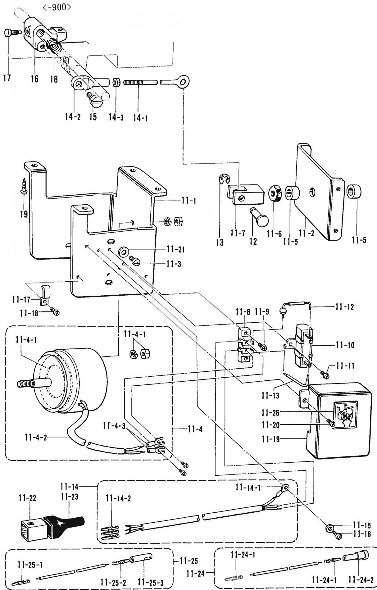
F. 押工上ヶ関係 / Work clamp lifter mechanism / Stoffhalterhebervorrichtung /
