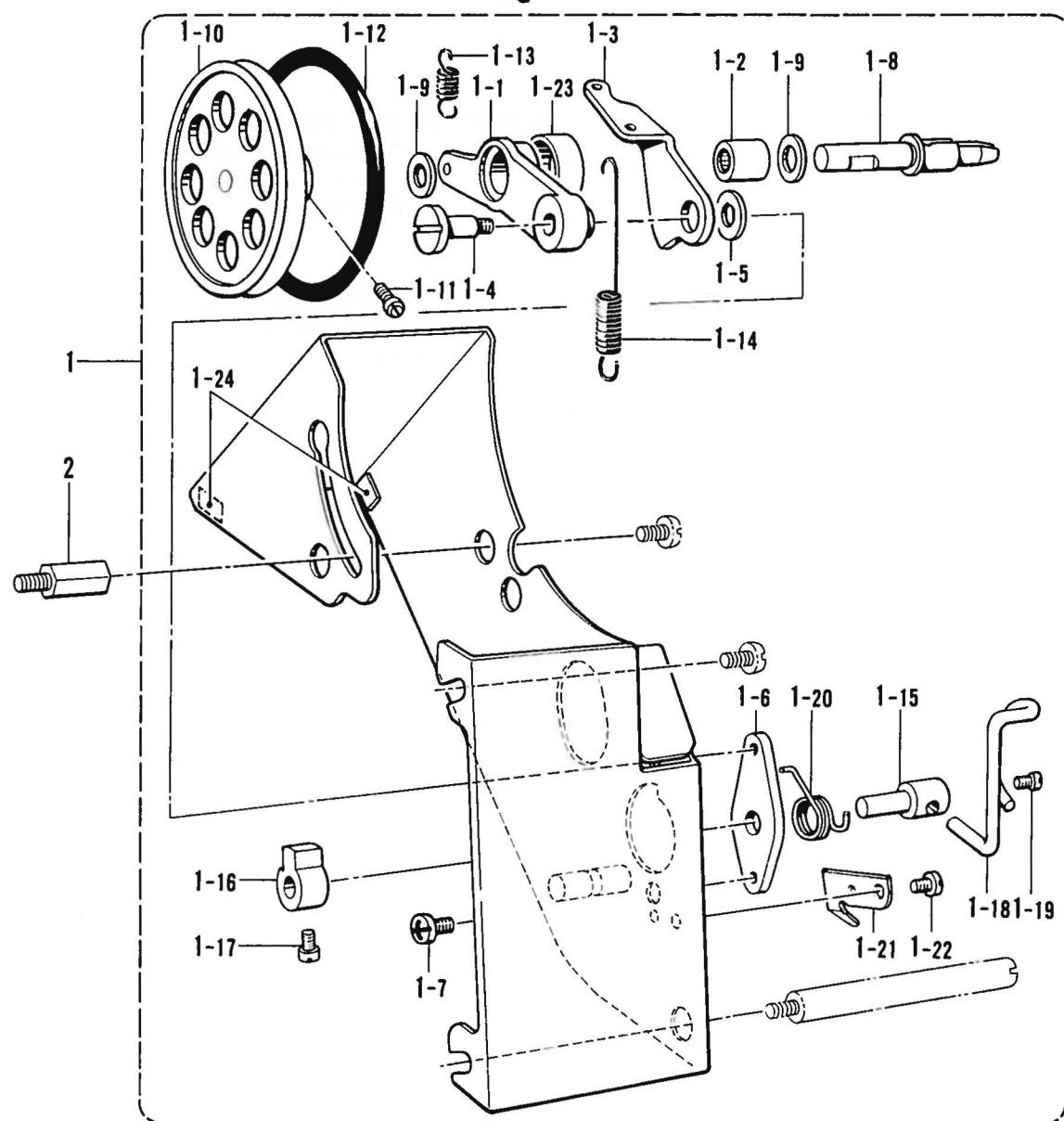
X. 糸巻キ装置関係 / Bobbin winder mechanism / Spuler /
