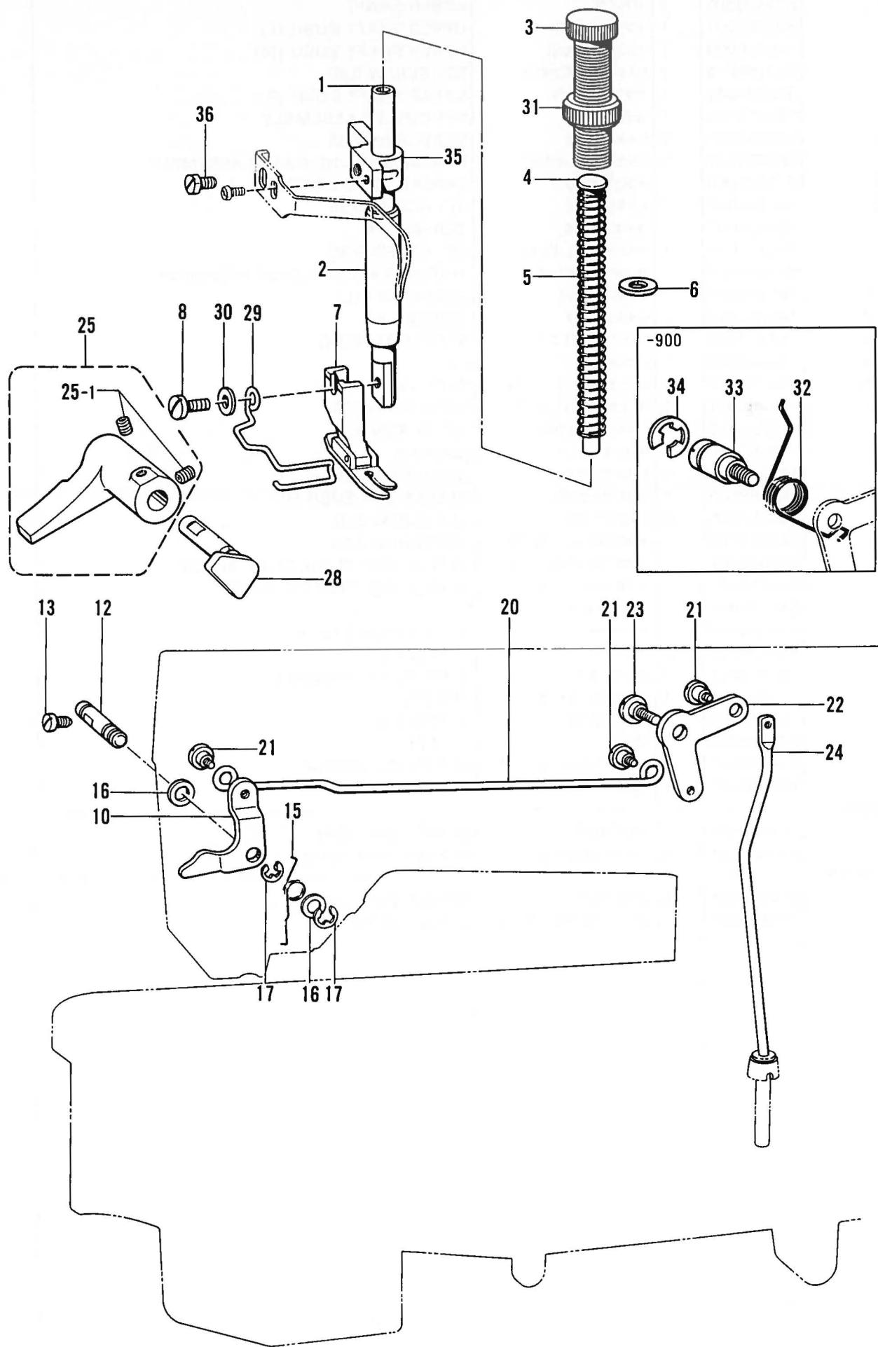
D. 押工関係/Presser foot mechanism/Stoffdrückerfuß/
