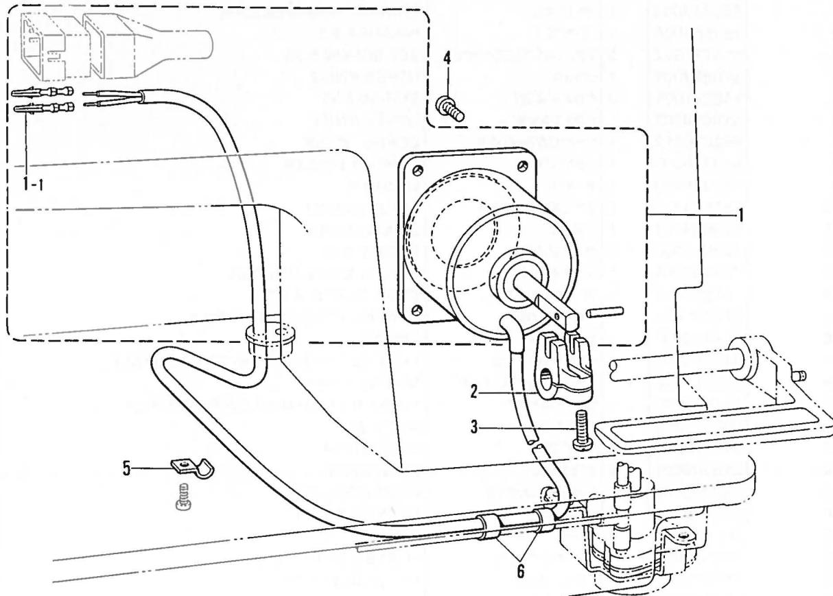
M. 糸ユルメ関係 / Tension release mechanism / Spannungsverminderungsvorrichtung /
