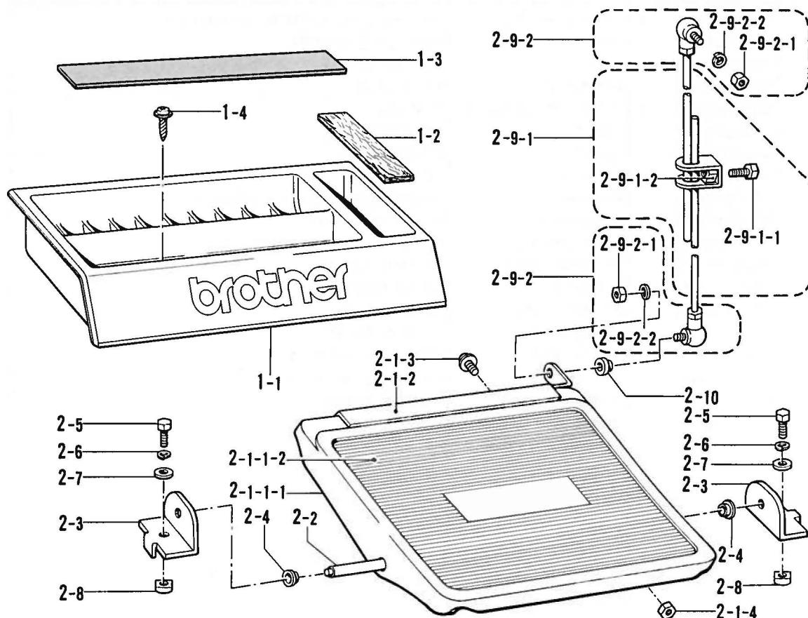
T. 布制御関係 / Cloth control system mechanism / Stoffführungs vorrichtung /
