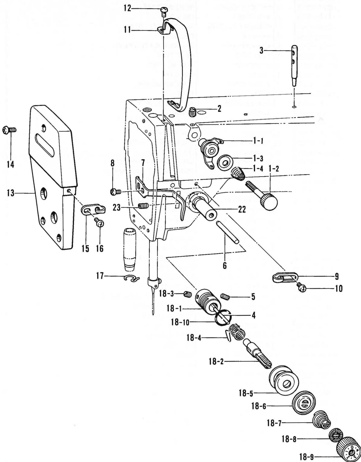
J. 糸通シ関係 / Threading mechanism / Fadenführungs vorrichtung /
