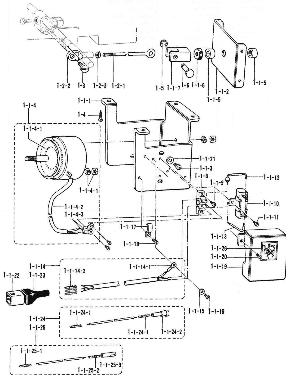
W1. 電磁押工上げセット / Presser foot lifting solenoid set / Solenoidsatz für die Anhebung des Stoffdrückerfußes /
