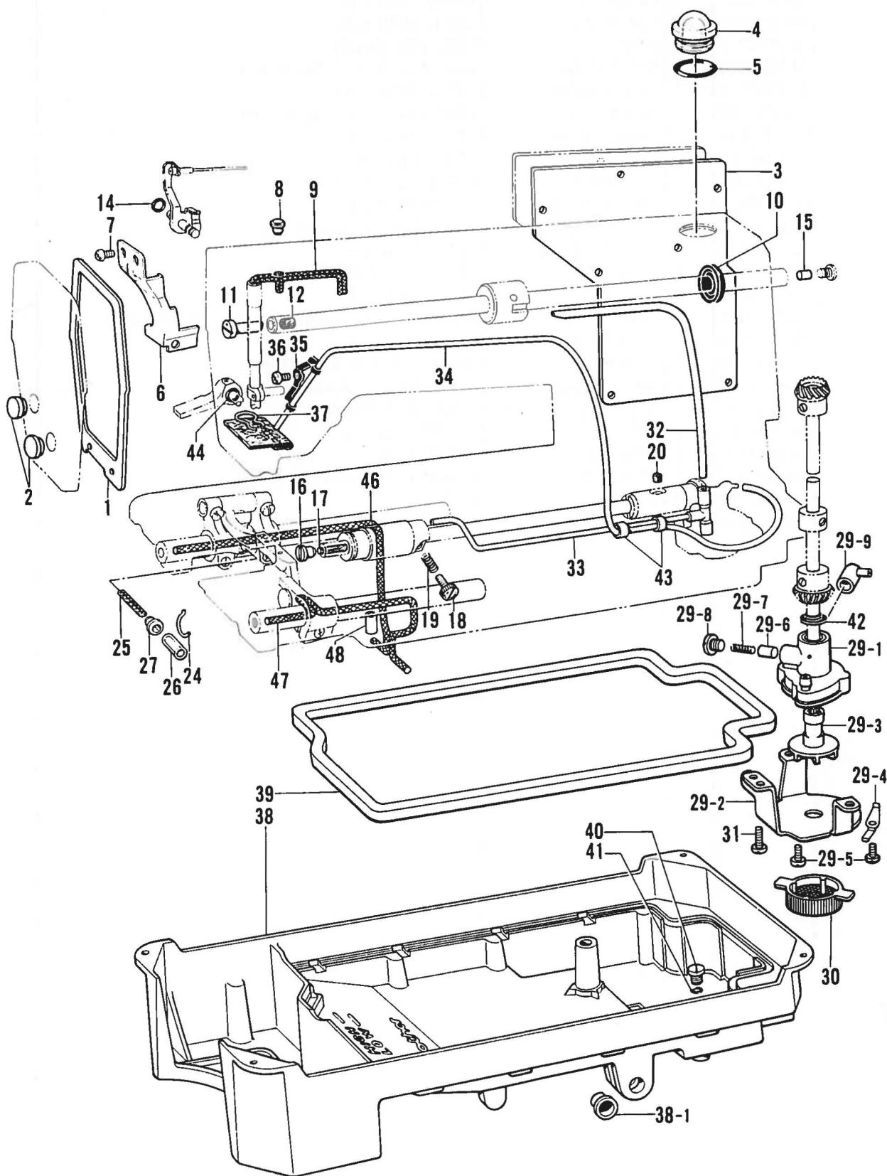
H. 給油潤滑関係/Lubrication/Schmierung/
