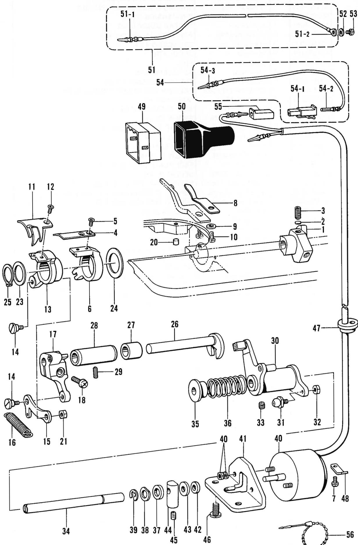
K. 糸切り関係/Thread trimmer mechanism/Fadenabschneidevorrichtung/
