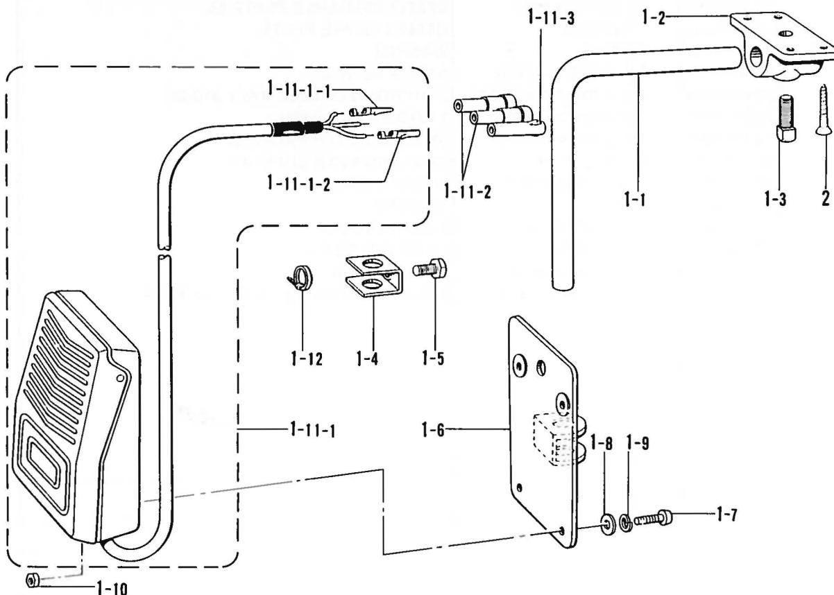
S. 逆転スイッチ関係 / Quick reverse switch mechanism / Umkehrschalter /
